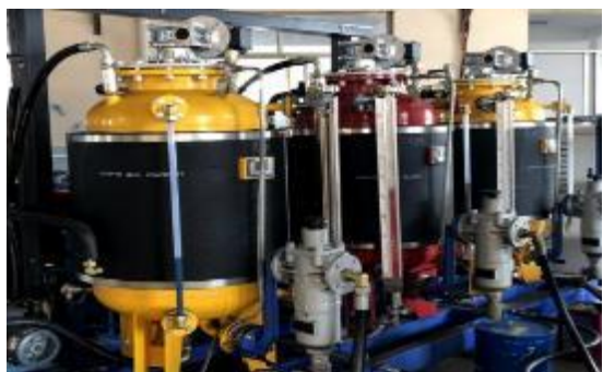
新型密封シクロペンチルシステム (6+2) 成分の一次発泡成形技術
