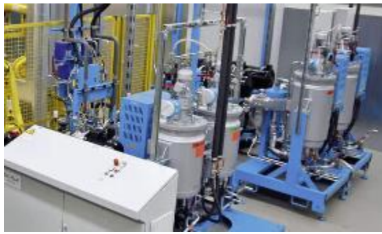
新型密封シクロペンチルシステム (6+2) 成分の一次発泡成形技術
