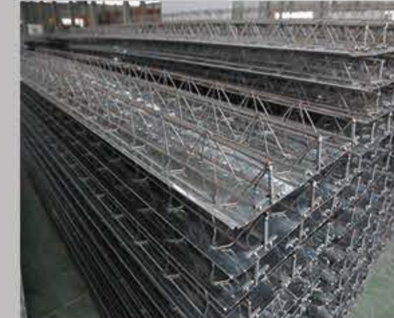
1. 生産が終わって輸送を待つ Truss deck in factory
